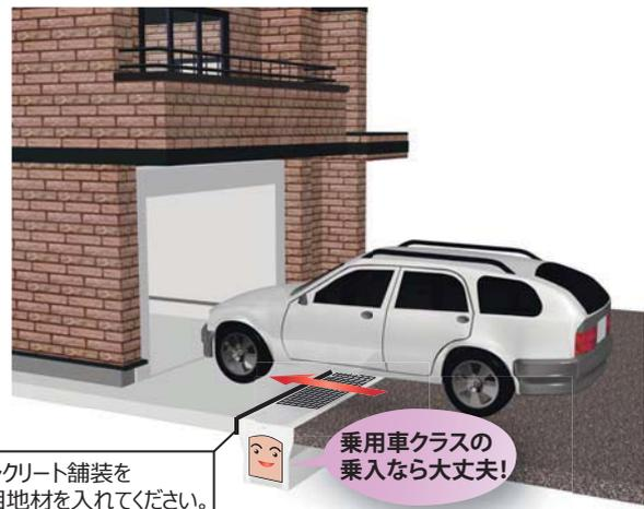
側溝に隣接してコンクリート舗装を施工する際には、目地材を入れてください。
